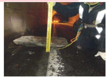
質量約170kgのコンクリート塊が剥落
