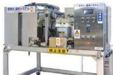
▲窒素水製造システム
