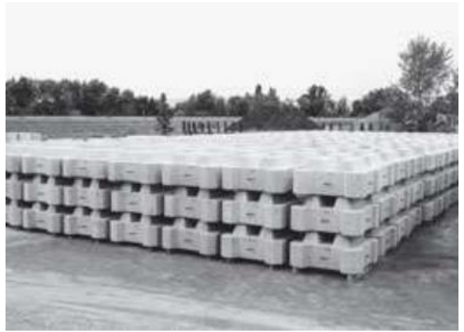
▲低炭素化した根固めブロック
