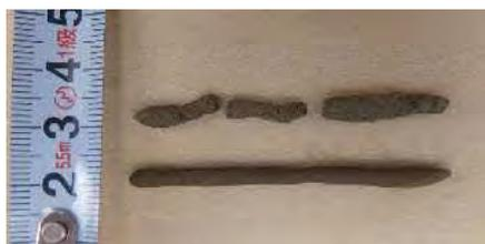
当該崩壊斜面では、灰色をしていても十分に粘土化したとはいえない火山灰土（「粘土化した火山灰土が少ない」に分類）が見受けられます。
