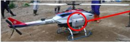
UAVの両脇に 粒子状の播種資材を積載
