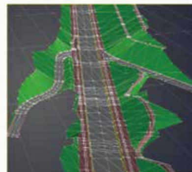
▲施工後のかたちも3次元で記録
