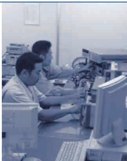
計測標準室(23°C±0.5)での電気計測器の校正。
