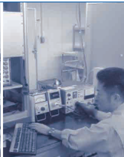
社内校正室での絶縁耐圧試験器の校正。
