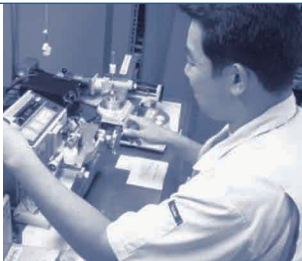
社内校正室でのトルクレンチの校正。
